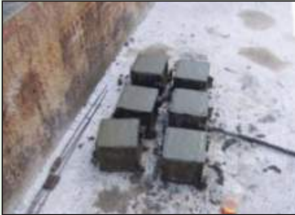
รูปที่ 5-29 การเก็บตัวอย่าง แท่งคอนกรีตลูกบาศก์
