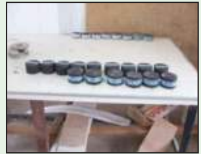
รูปที่ 3-14 แสดงการทำก้อนตัวอย่าง เพื่อหาค่า Density Stability &amp; Flow
