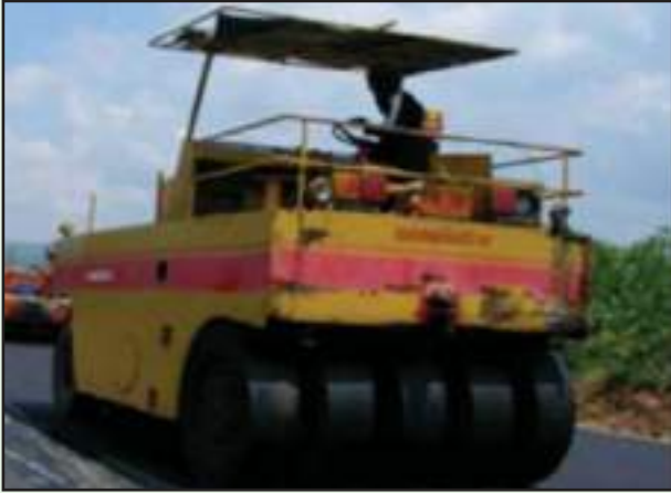
รูปที่ 6-22 รถบดล้อยางชนิด 11 ล้อ
