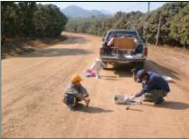
รูปที่ 4-31 การทดสอบความแน่นโดยวิธีทรายนมแทนที่
