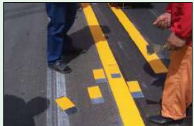
รูปที่ 7-12 การเก็บตัวอย่างเพื่อตรวจสอบคุณภาพสี
