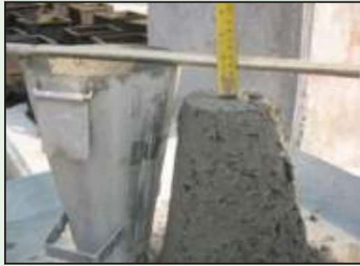
รูปที่ 3-17 การตรวจสอบค่าการยุบตัว (Slump Test)
