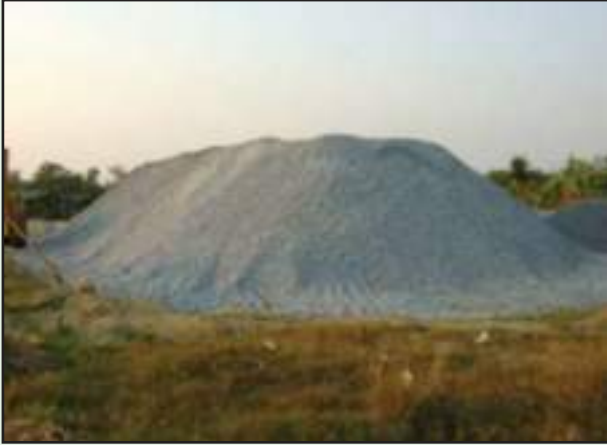
รูปที่ 4-45 กองสต็อกหินคลุก
