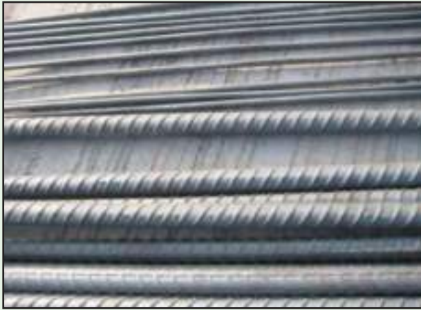
รูปที่ 3-16 เหล็กข้ออ้อย (Deformed Bar) และเหล็กเส้นกลม (Round Bar)
